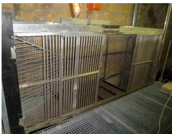
Pic. 13 : Tuilières trapping device
