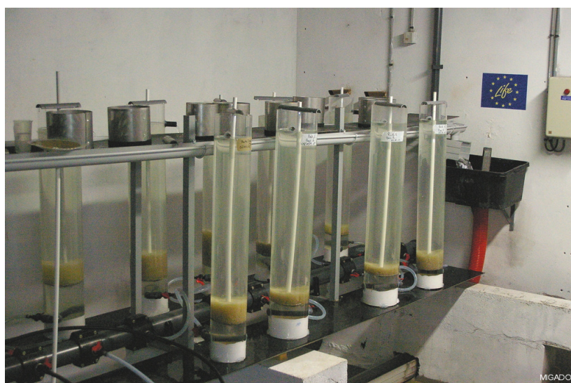
Photographie 11 : Table d'incubation en fonctionnement, adduction et collecte de l'eau
