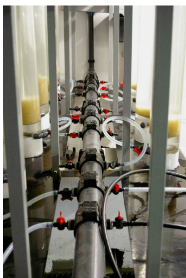
Photographie 11 : Table d'incubation en fonctionnement, adduction et collecte de l'eau
